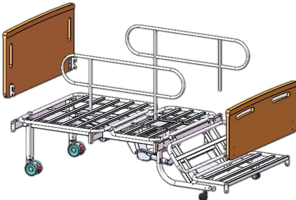
11. 取床头护栏按图对齐，并向下插入固定。
