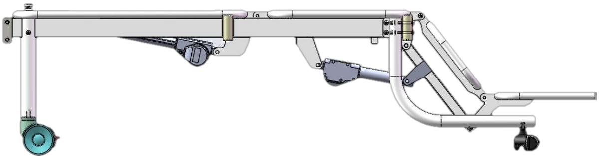
10. 取两个电机按图指示方向对齐孔，取  $\Phi 10*50$  圆柱销穿入并用 B 型卡扣固定圆柱销，并把电机插头插入控制盒对应插孔。
