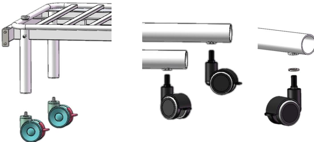
7. 取四只脚轮并按图对齐相关位置并拧紧，床尾脚轮须加  $\Phi 12$  弹垫
