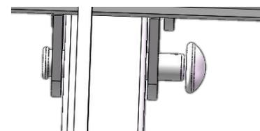
9. 取腿部升降转轴并按图对齐相关孔(注意电机连接座的方向), 取  $\Phi 10*50$  圆柱销穿入与床架连接孔并用  $\Phi 10$  卡扣扣紧两侧相同。
