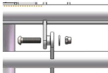
8. 取大腿板按图对齐孔，并取得  $M8*30$  内六角螺栓、 $\Phi 8*5$  塑料垫圈、 $M8$  螺母按图对齐并用扳手拧紧两侧相同。小腿板采取同样方式安装
