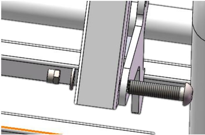
取 M10\*50 半圆头内六角穿入与小腿板连接孔，加  $\Phi 10$  铁垫圈并用扳手拧紧螺母，两侧相同。
